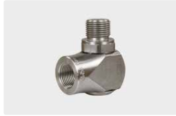
3/8" F : 3/8" M. Max. 400 bar / 30 r.p.m. / 90 °C
