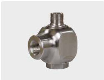
3/8" F : 3/8" M. DN 10. Max. 400 bar / 30 r.p.m. / 90 °C
