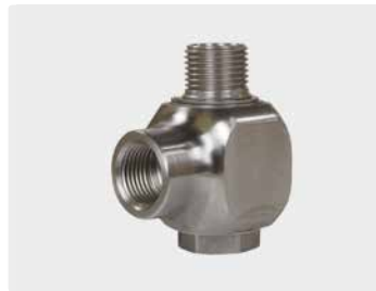
1/2" F : 1/2" M. DN 12. Max. 300 bar / 30 r.p.m. / 90 °C
