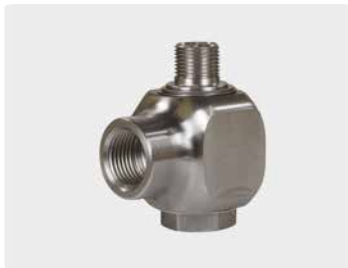
1/2" F : 3/8" M. DN 10. Max. 300 bar / 30 r.p.m. / 90 °C
