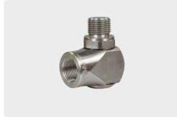
3/8" F : 3/8" M. DN 6. Max. 400 bar / 30 r.p.m. / 90 °C
