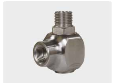
1/2" F : 1/2" M. DN 12. Max. 300 bar / 30 r.p.m. / 90 °C
